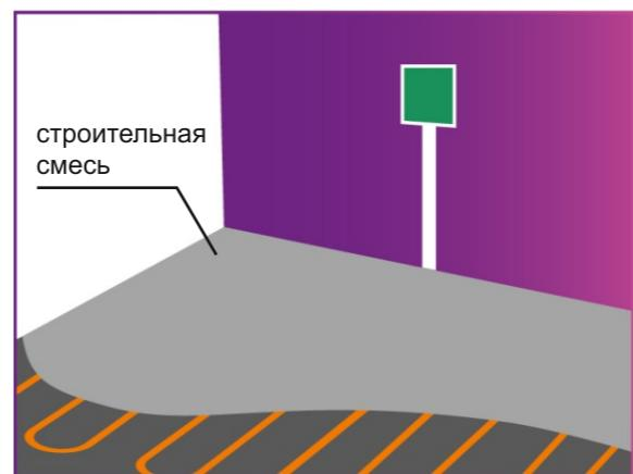
Покройте кабель слоем строительной смеси, пункт 9 раздела «Порядок монтажа» и повторно измерьте омическое сопротивление.
