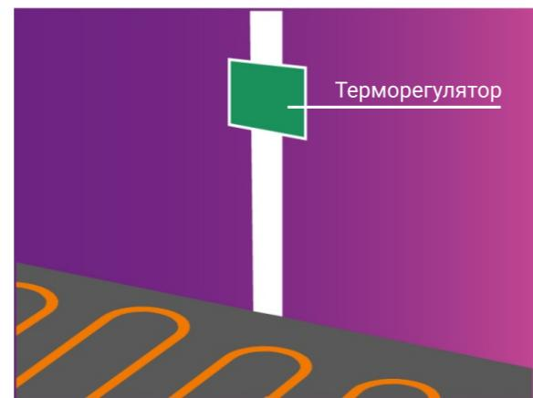
Измерьте омическое сопротивление кабеля, чтобы проверить работу системы, сверив показания с таблицей «Параметры 2-х жильных секций нагревательных». Подключите систему к терморегулятору.
