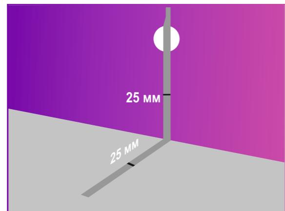
В месте установки терморегулятора в стене и в полу сделайте штробу 25x25 мм необходимой длины, пункт 2 раздела «Порядок монтажа».
