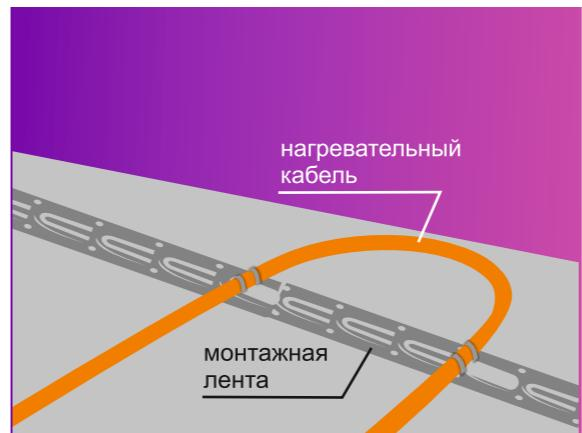
Монтажная лента предназначена для укладки секций нагревательных с постоянным шагом и фиксации их на поверхности пола, пункт 3 «Порядок монтажа».
