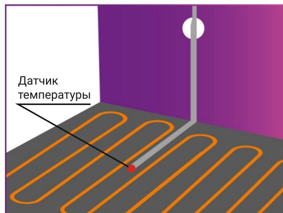
Установите датчик температуры пола, согласно пункта 7 раздела «Порядок монтажа».
