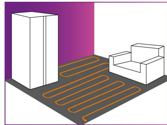
Разложите и зафиксируйте секцию нагревательную по всей поверхности пола, согласно составленного чертежа, пункт 4,5 раздела «Порядок монтажа».
